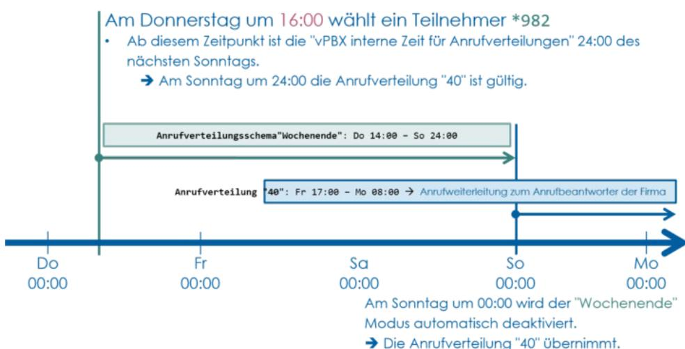
Das Anrufverteilschema kann vom vPBX Administrator im AdminCenter mittels Konfiguration des Parameters "Zeitschaltung" umgeschaltet werden.
